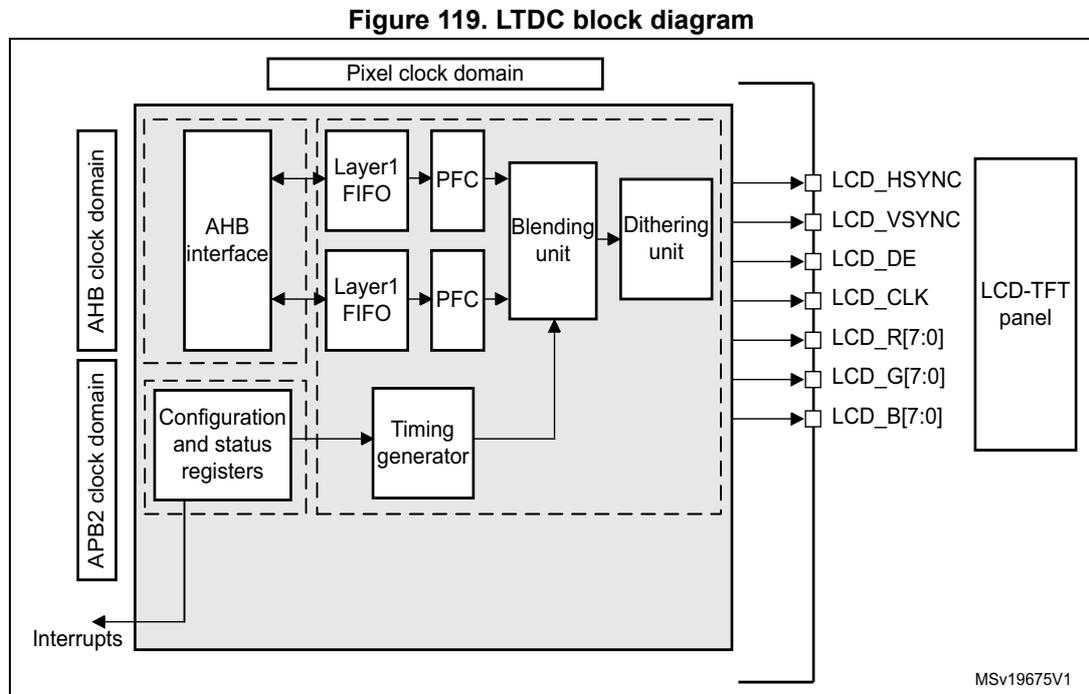
Layer FIFO: One FIFO 64x32-bit per layer.
