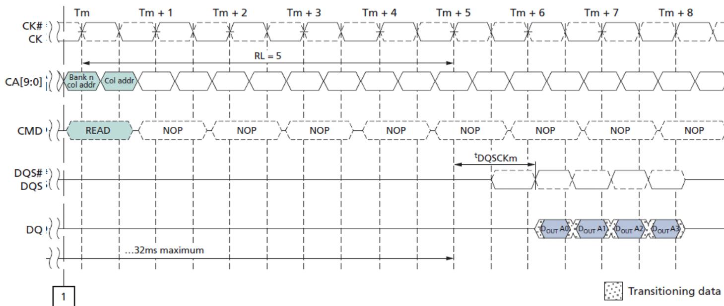
Notes : 1.  $t_{DQSKDL} = (t_{DQSKn} - t_{DQSKm})$ .
